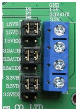
主機板供電 Jumper 接法
