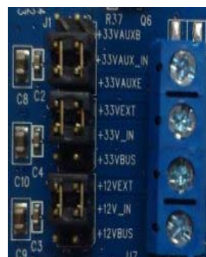
外部供電 Jumper 接法
