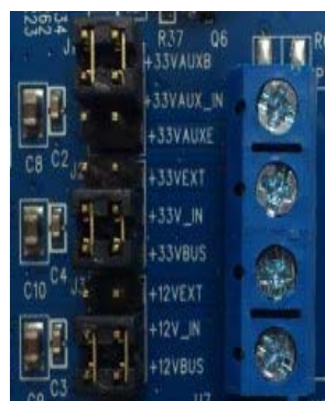
主機板供電 Jumper 接法
